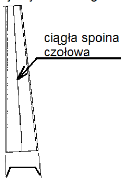
Rys. 8. Pale specjalne wykorzystywane do zniwelowania pochylenia ścianki
